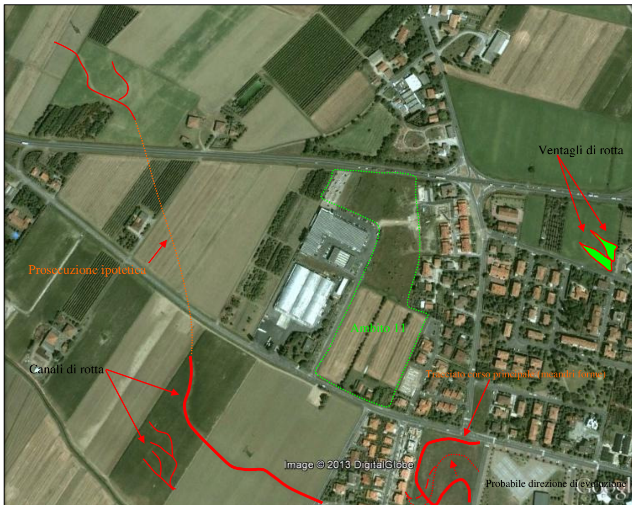
Figura 5.2. Fotoaerea del novembre 2003 estratta dal sito Google earth (non in scala) con ricostruzione delle paleo strutture riconoscibili.
